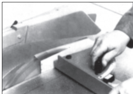
C Empujar la pieza y el tope angular hacia delante. Después del corte retraer el tope de cuña y el tope angular
